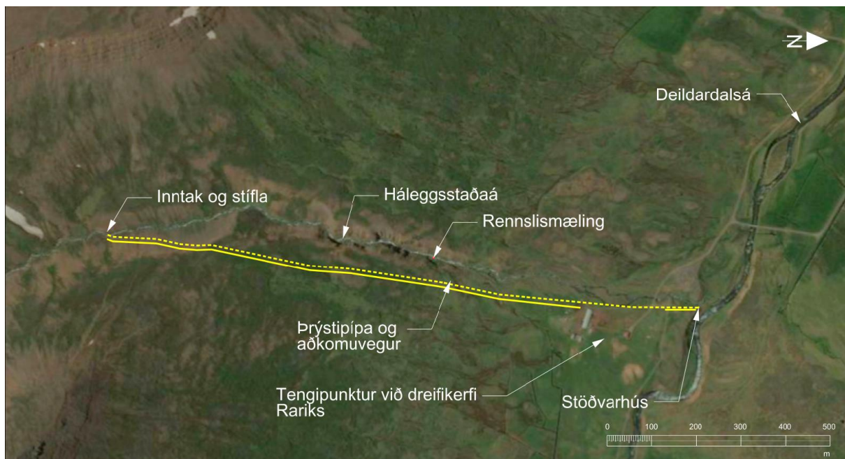
Mynd 1. Yfirlitsmynd virkjunar í Háleggsstaðaá
